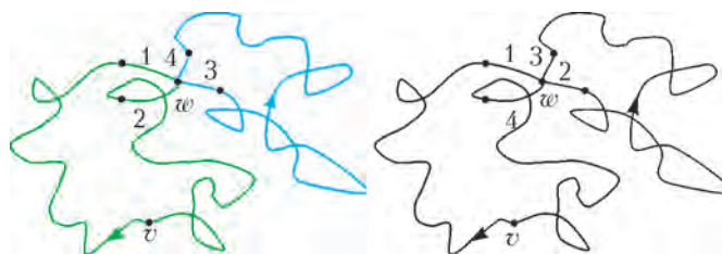
Рис.18. Объединение циклов. Если два цикла проходят через одну и ту же вершину w , то их можно объединить в один цикл, просто поменяв порядок прохода вершин, выходящих из w
